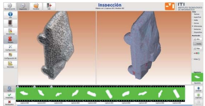
Figura 4: Reconstrucción a partir de un modelo CAD.
